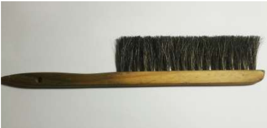
Escova para remover sujeiras de cima do desenho e da área de trabalho.
